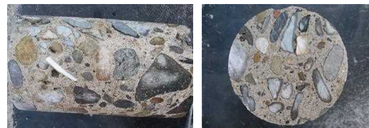
写真2 試験体のカット面から観察される骨材形状
