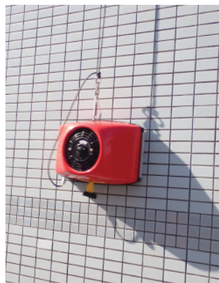
ロボの走査状況を録画し、打診音を録音します。
