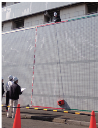
地上にビデオカメラとワイヤレス集音装置を設置します。
