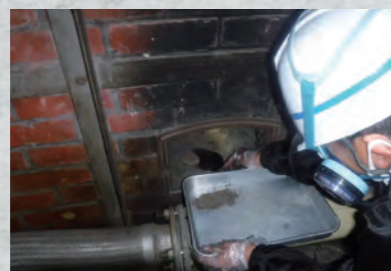
ダイオキシン調査(煙突焼却灰)
