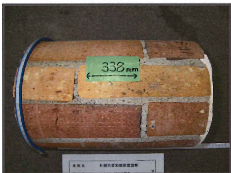
使用煉瓦材の物性調査 (目地モルタルせん断耐力)
