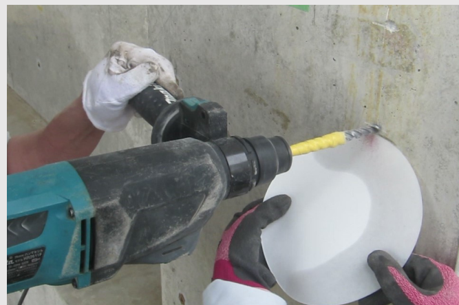
ドリル削孔粉を利用した中性化深さ測定
