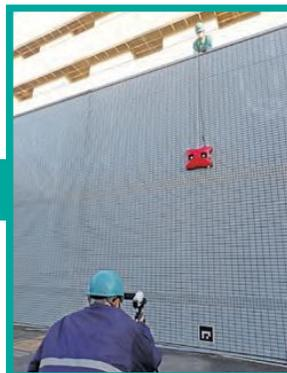
地上部にビデオカメラとワイヤレス集音装置を設置します。
