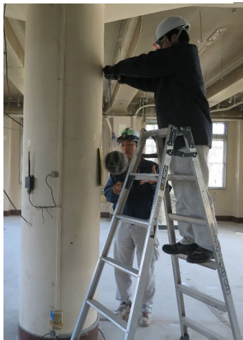
A:ウィンザーピンの試験状況 B:ピン貫入深さを専用のマイクロメータで測定している状況(深さの値から換算表を使って強度を推定する)
