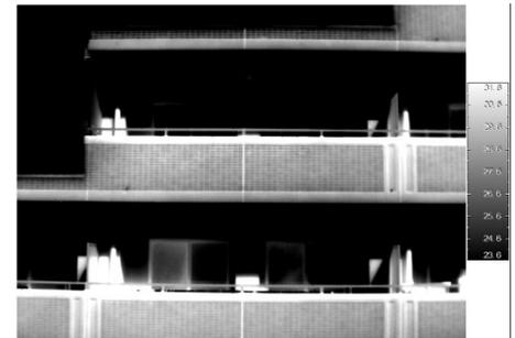
CONSFINDER-SKY によって撮影された熱画像の例 (高い位置でも正対した画像を取得できる。診断のためのモノクロ表示)
