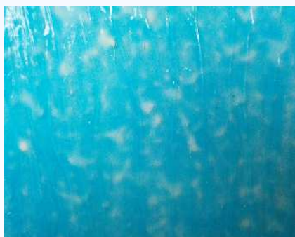
軟化・膨潤するまで放置し、塗膜の膨潤後に剥離・除去
