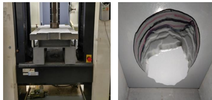
押抜き試験状況
