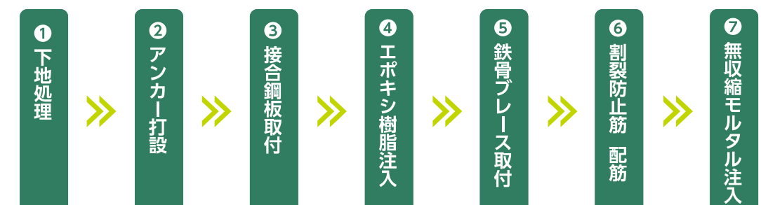
⑤ 鉄骨ブレース取付 ⑥ 割裂防止筋 配筋
