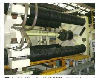
■ オイルダンパー性能試験。フルストロークによる全品性能試験を行います。
