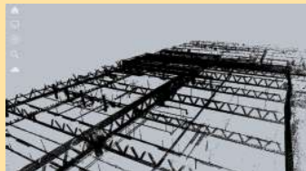
点群を用いて梁の形状と位置を確認
