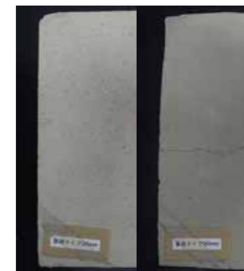
耐火試験後の外観 平成12年建設省告示1399号の基準を 満足することを確認しています。
