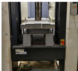
押抜き試験状況
