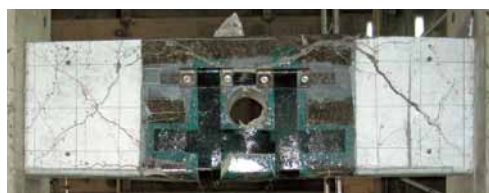
リダブル補強試験体 最大加力時写真
