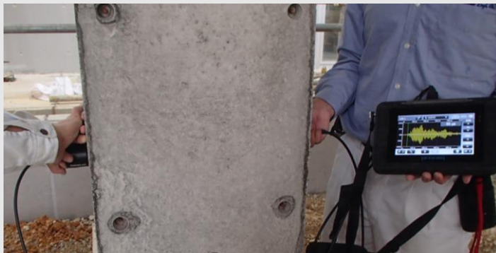
超音波法によるコンクリート内部状態の調査状況
